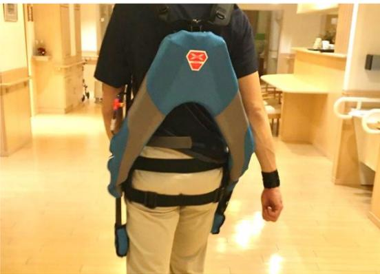
写真=マッスルスーツを使用している様子 CMでもおなじみのマッスルスーツを着用し腰への負担をなくします
