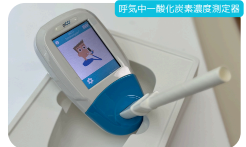
呼気中一酸化炭素濃度測定器
